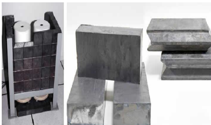
شکل ۹۷- استفاده از آجرهای سربی جهت ایجاد محیط‌های ایزوله
