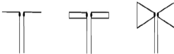
شکل ۳۱- آنتن دوقطبی کوچک به‌عنوان پروب میدان الکتریکی
