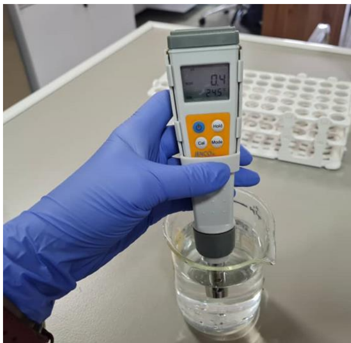
شکل ۱۳ اندازه گیری میزان هدایت آب تولید شده از دستگاه آب دیونیزه ساز
