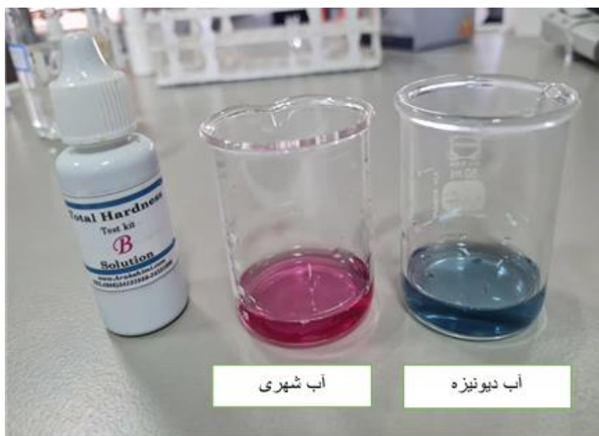
شکل ۱۲ تعیین سختی آب تولید شده از دستگاه آب دیونیزه ساز
