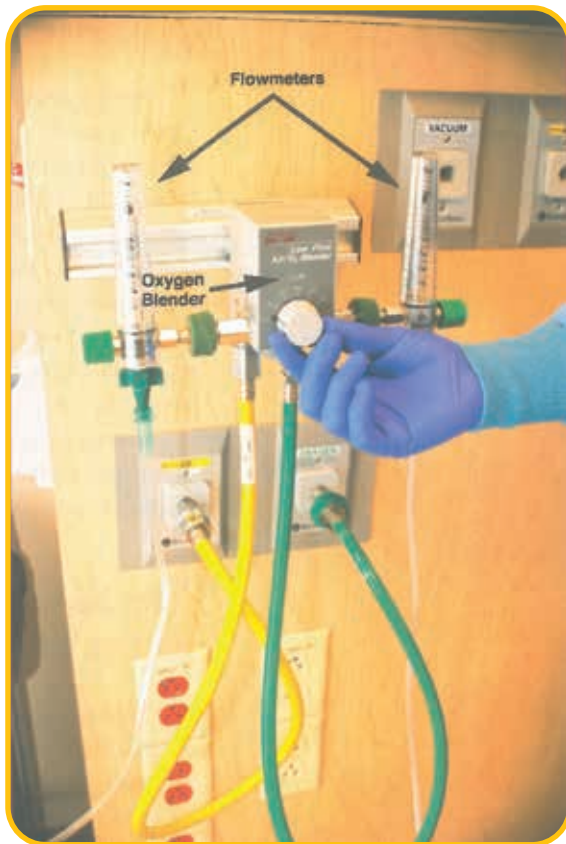
شکل ۱۷.۳. غلظت اکسیژن را با هوای فشرده (خروجی زرد)، اکسیژن فشرده (خروجی سبز)، مخلوط کننده اکسیژن، یک جریان سنج و یک لوله خروجی به بیمار (لوله شفاف) تنظیم نمایید. در این شکل ۲ جریان سنج به مخلوط کننده اکسیژن وصل است. دستگاه شما ممکن است تنها ۱ جریان سنج داشته باشد.
